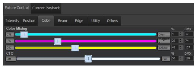
FIGURE 11. NEO CONSOLE COLOR MIX CONTROL USING CMY
