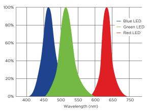
FIGURE 4. ILLUSTRATION OF RGB LEDS1
